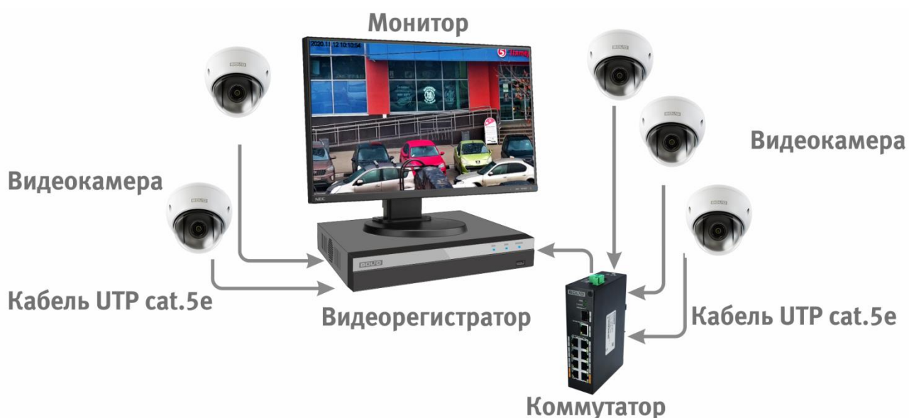
Рисунок 6.4 – Схема подключения видеокамеры к видеорегистратору
