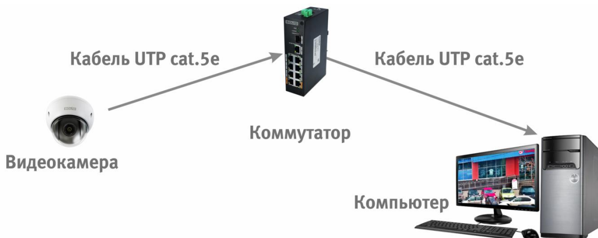
Рисунок 6.3 – Схема подключения видеокамеры к компьютеру через коммутатор
