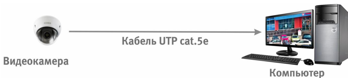
Рисунок 6.2 – Схема подключения видеокамеры к компьютеру
