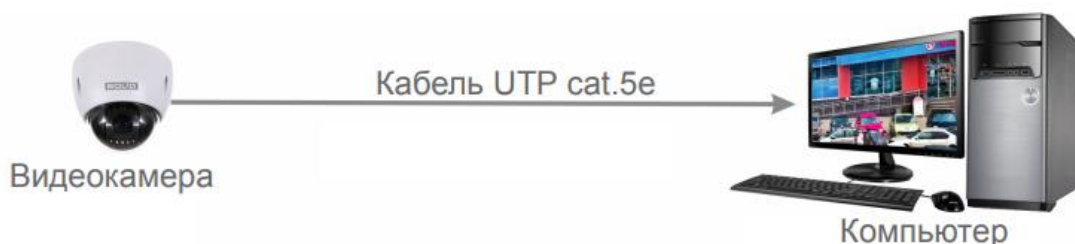
Рисунок 6.2 – Схема подключения видеокамеры к компьютеру
