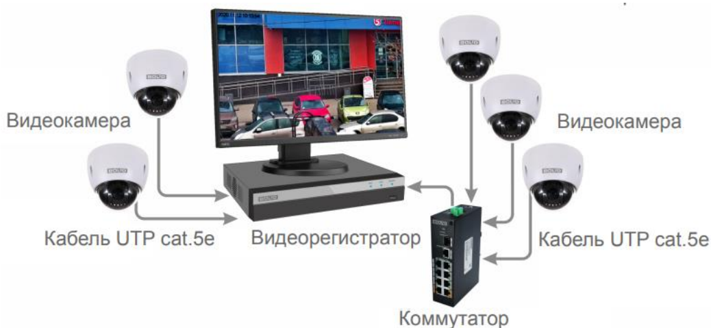
Рисунок 6.4 – Схема подключения видеокamеры к видеорегистратору
