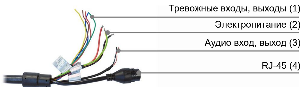
Рисунок 6.1 – Группы концевой раскладки кабеля видеокмеры
