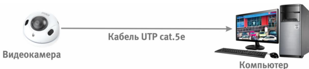
Рисунок 6.2 – Схема подключения видеокамеры к компьютеру
