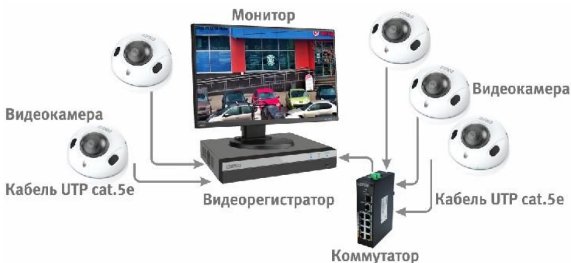
Рисунок 6.4 – Схема подключения видеокamеры к видеорегистратору
