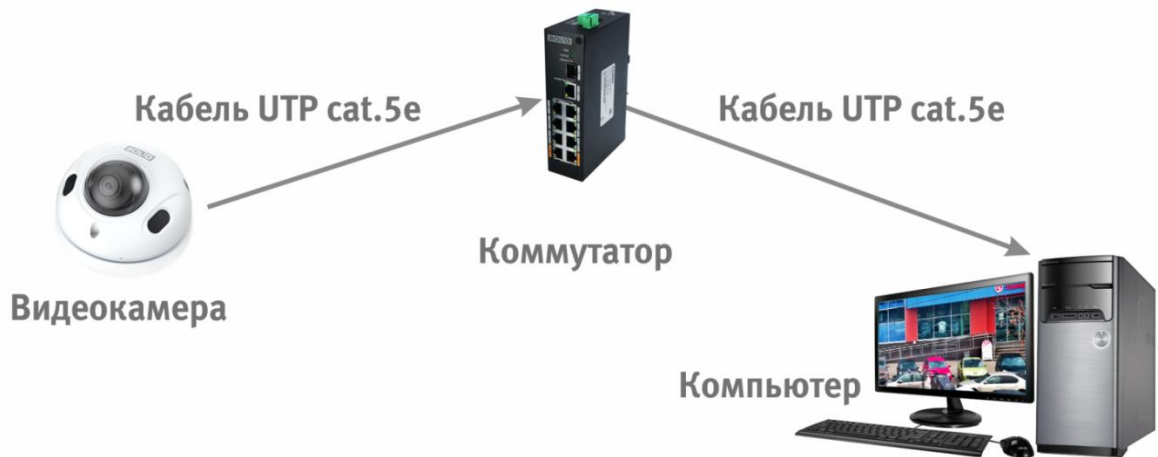
Рисунок 6.3 – Схема подключения видеокамеры к компьютеру через коммутатор
