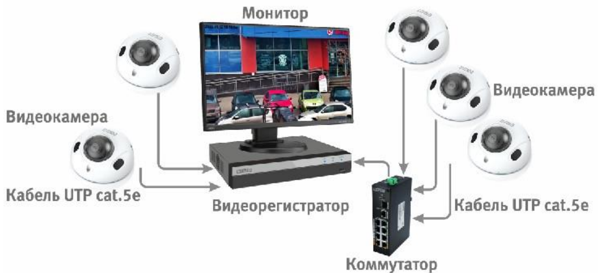
Рисунок 6.4 – Схема подключения видеокамеры к видеорегистратору
