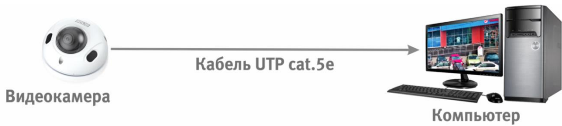
Рисунок 6.2 – Схема подключения видеокамеры к компьютеру
