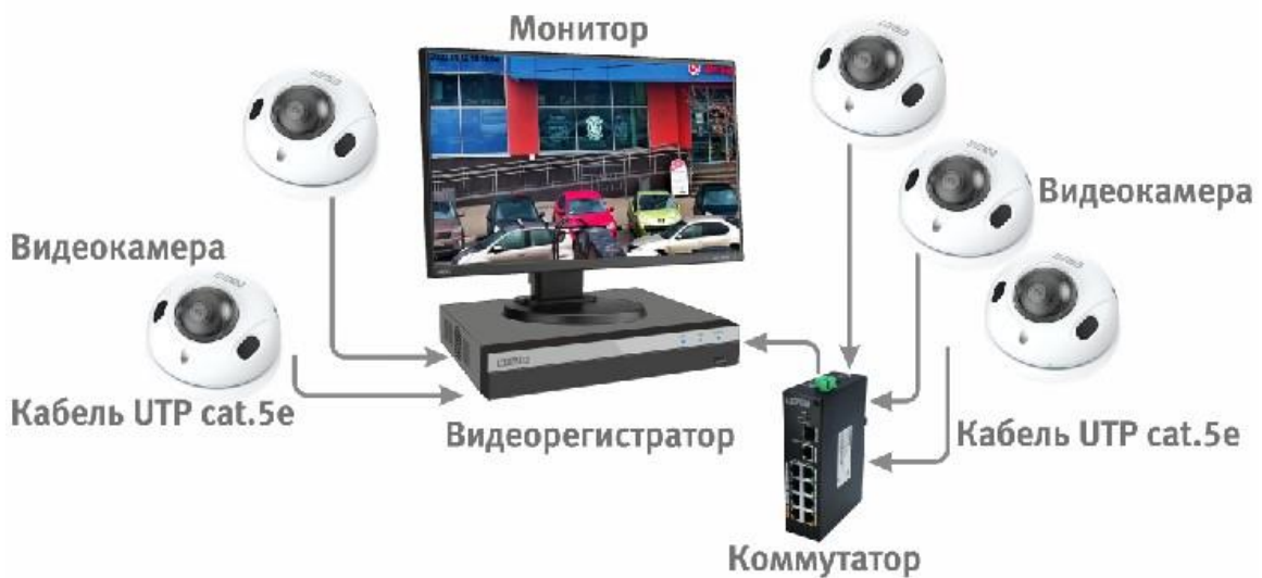
Рисунок 6.4 – Схема подключения видеокамеры к видеорегистратору
