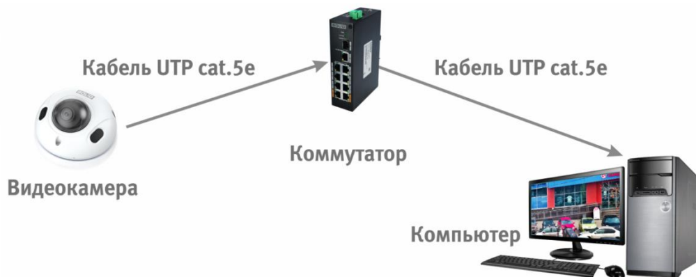
Рисунок 6.3 – Схема подключения видеокамеры к компьютеру через коммутатор
