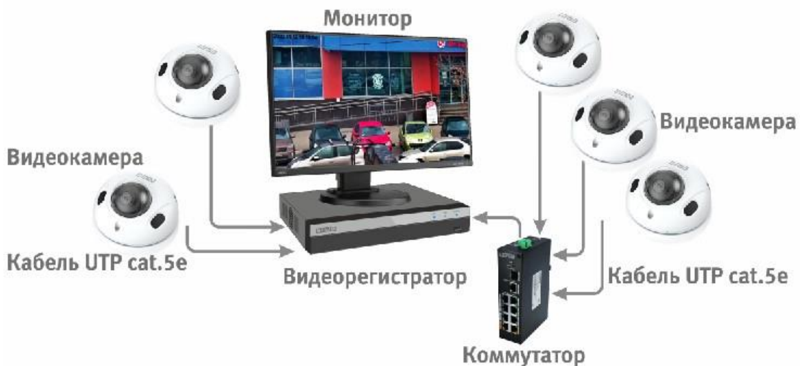
Рисунок 6.4 – Схема подключения видеокамеры к видеорегистратору
