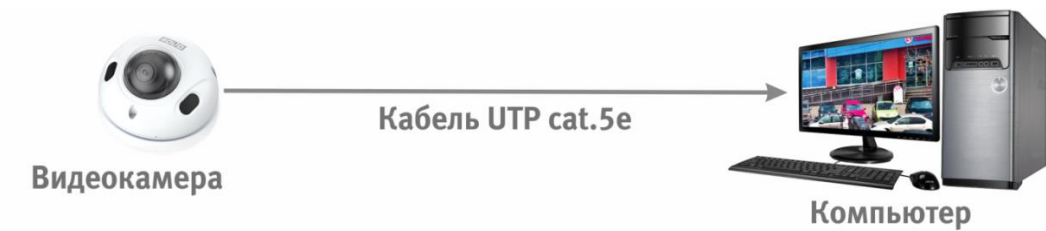
Рисунок 6.2 – Схема подключения видеокамеры к компьютеру
