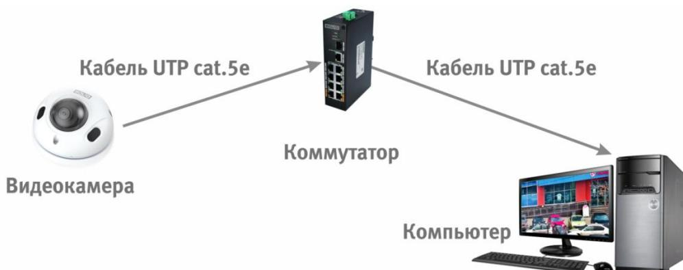
Рисунок 6.3 – Схема подключения видеокамеры к компьютеру через коммутатор
