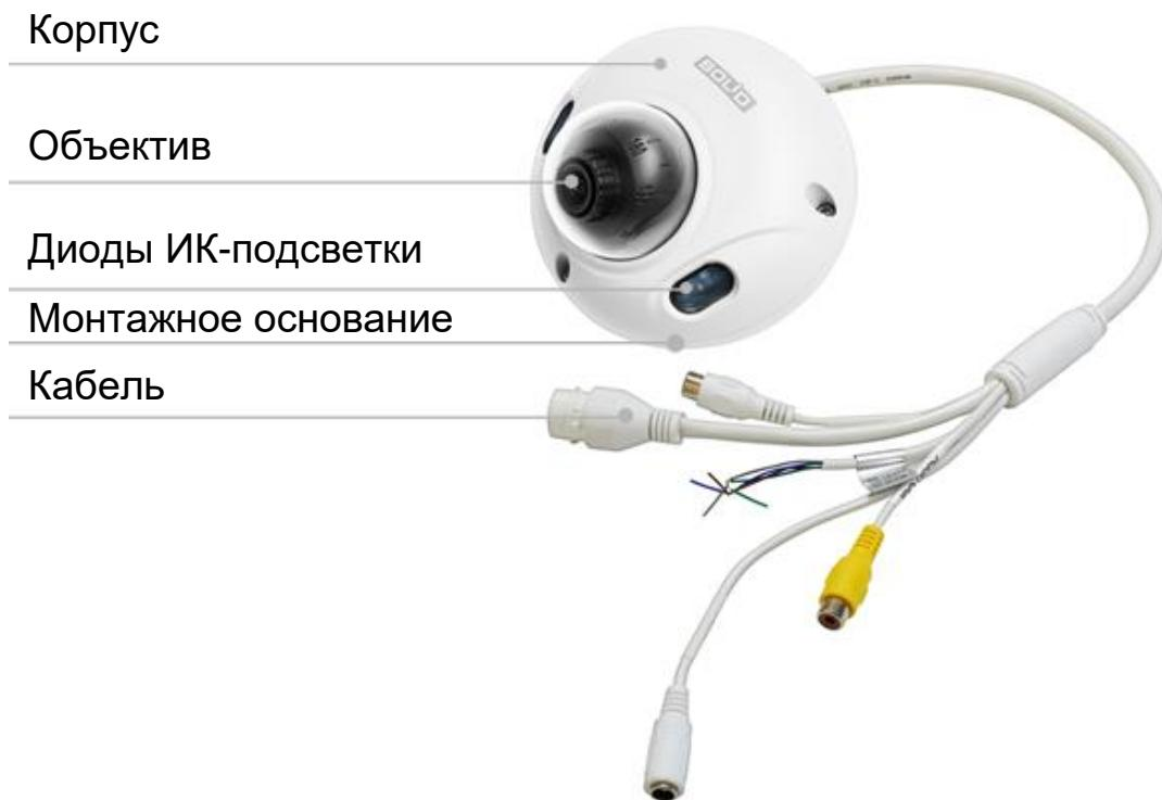
Рисунок 4.1 – Внешний вид и основные элементы видеокамеры
