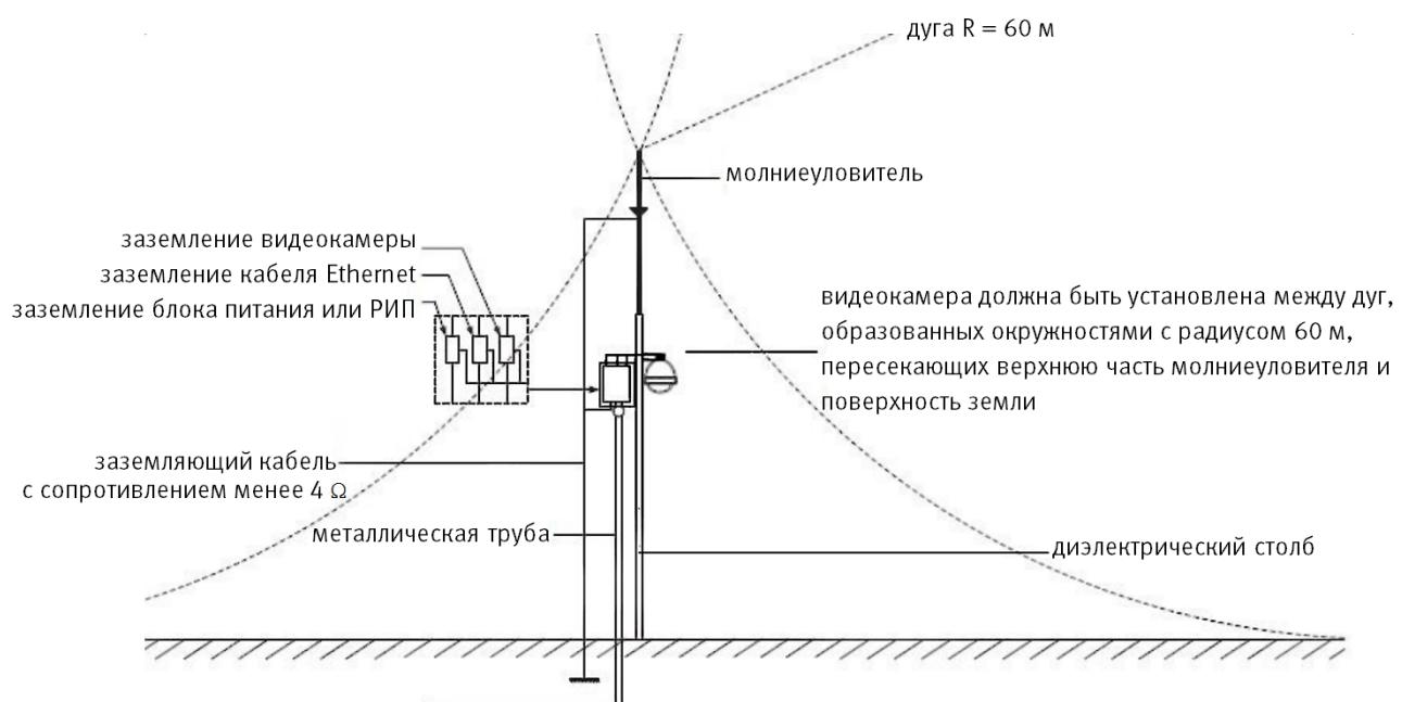
Рисунок 6.13 – Установка молниеотвода
