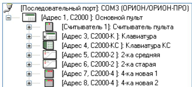
Рисунок 26. Дерево объектов протокола "Орион Про"
