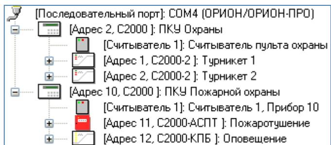
Рисунок 27. Дерево объектов протокола "Орион Про"
