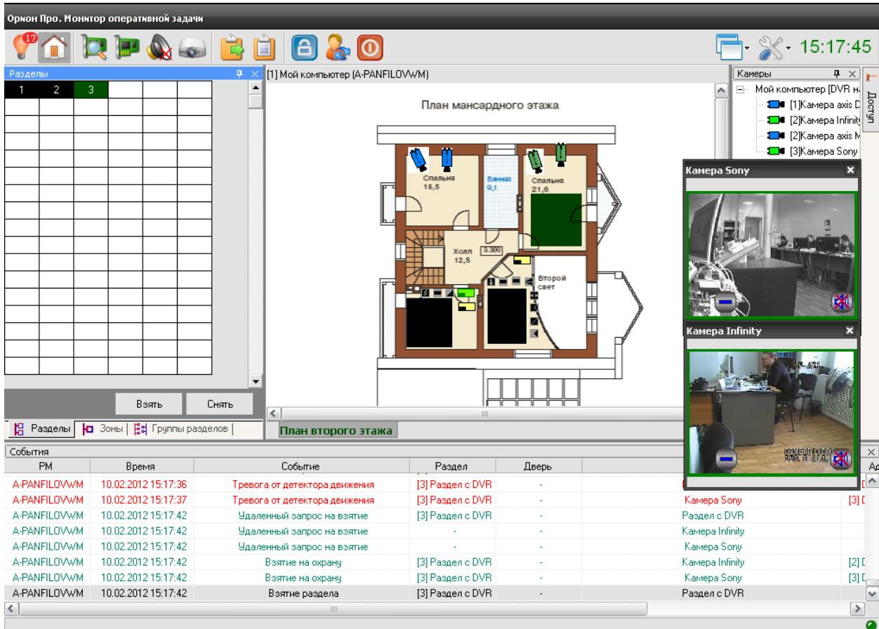
Справа на данной иллюстрации монитора оперативной задачи видны окна видеоизображения с двух подключенных к DVR видеорегистратору камер.
