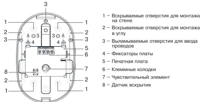
Рисунок 2 – Основание с установленной печатной платой
