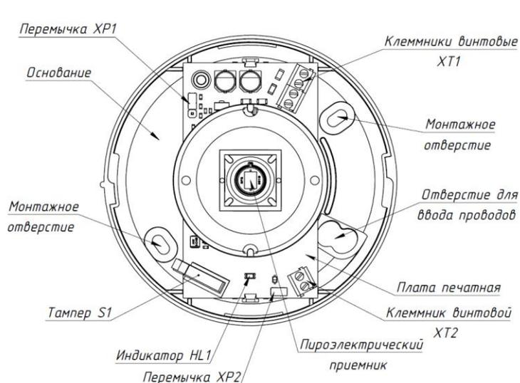
Рис.2.2.2.1. Конструкция извещателя
