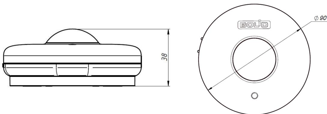
Рис.2.2.2.3. Габаритные размеры извещателя
