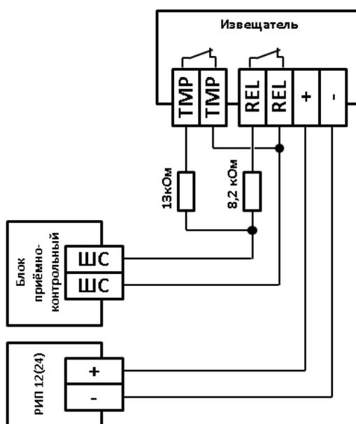
**Рис.2.2.4.2** Схема с общим шлейфом тревоги и контроля вскрытия, для ШС типа 5 «Охранный с контролем блокировки» (для приборов Сигнал-10/20М/20П, С2000-4).
