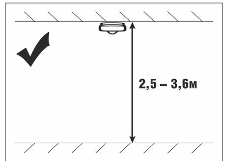
Рис.2.2.3.3.7. Рекомендуемая высота установки извещателя - 2.5-3.6м над полом.
