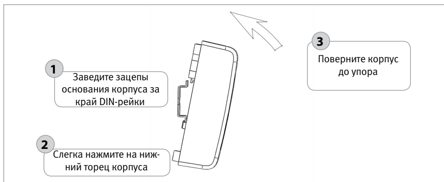
Рисунок 22. Порядок установки прибора на DIN-рейку
