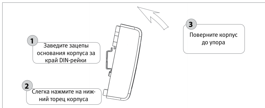
Рисунок 2. Установка блока «С2000-СП1 исп.01» на DIN-рейку
