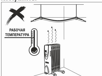
Рис. 7 – Запрещается превышать максимальную рабочую температуру эксплуатации термокабелей на объекте.
