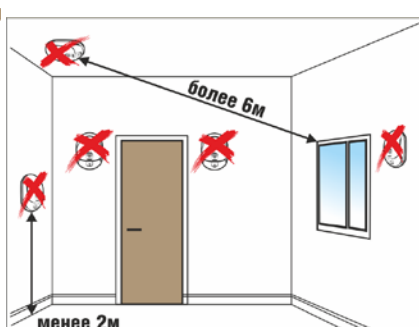
Рисунок 2.2.3.2.6 НЕрекомендуемые места установки извещателя
