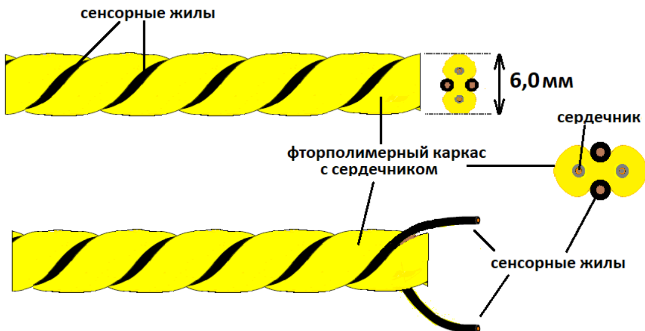
Рис. А1 – Структура сенсора чувствительного элемента М3000-КПВ-СК
