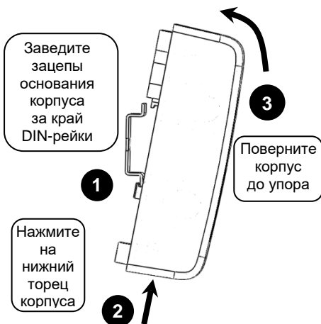
Рисунок 3. Крепление контроллера на DIN-рейку
