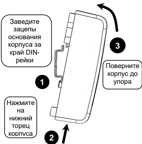
Рисунок 3. Крепление контроллера на DIN-рейку
