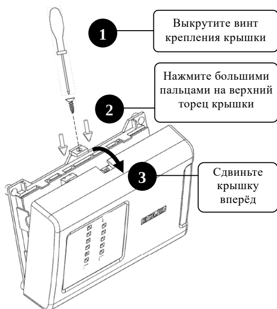
Рисунок 2.2.2. Снятие крышки прибора
