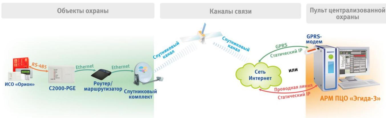
В качестве приёмо-передающего оборудования на объектах охраны используются комплекты ООО «РАДУГА-ИНТЕРНЕТ». Оператор осуществляет передачу данных на основе технологий спутникового интернета и VSAT по всей территории РФ, что позволяет решать новые задачи мониторинга объектов:
