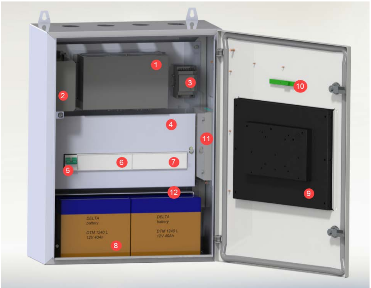
Рисунок 2-1. Компоновка элементов ППО КСПИ Эгида
