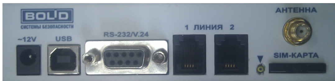
Рисунок 2-5. Задняя крышка «УОП-3 GSM» с разъемами
