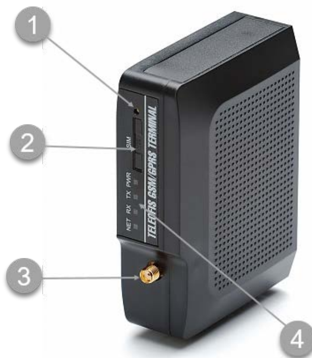
Рисунок 2-6. Внешний вид GSM модема Teleofis RX100-R2 в составе ППО КСПИ Эгида
