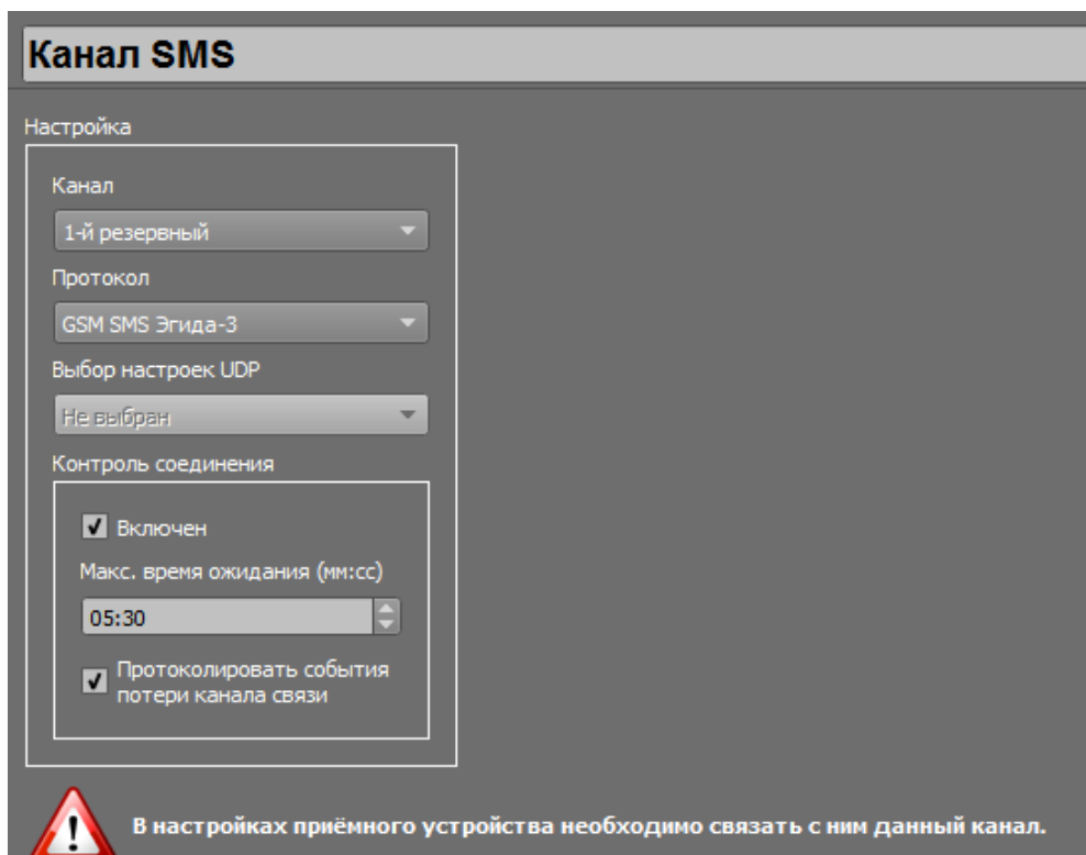
Рисунок 3-53. Пример настройки канала GSM SMS
