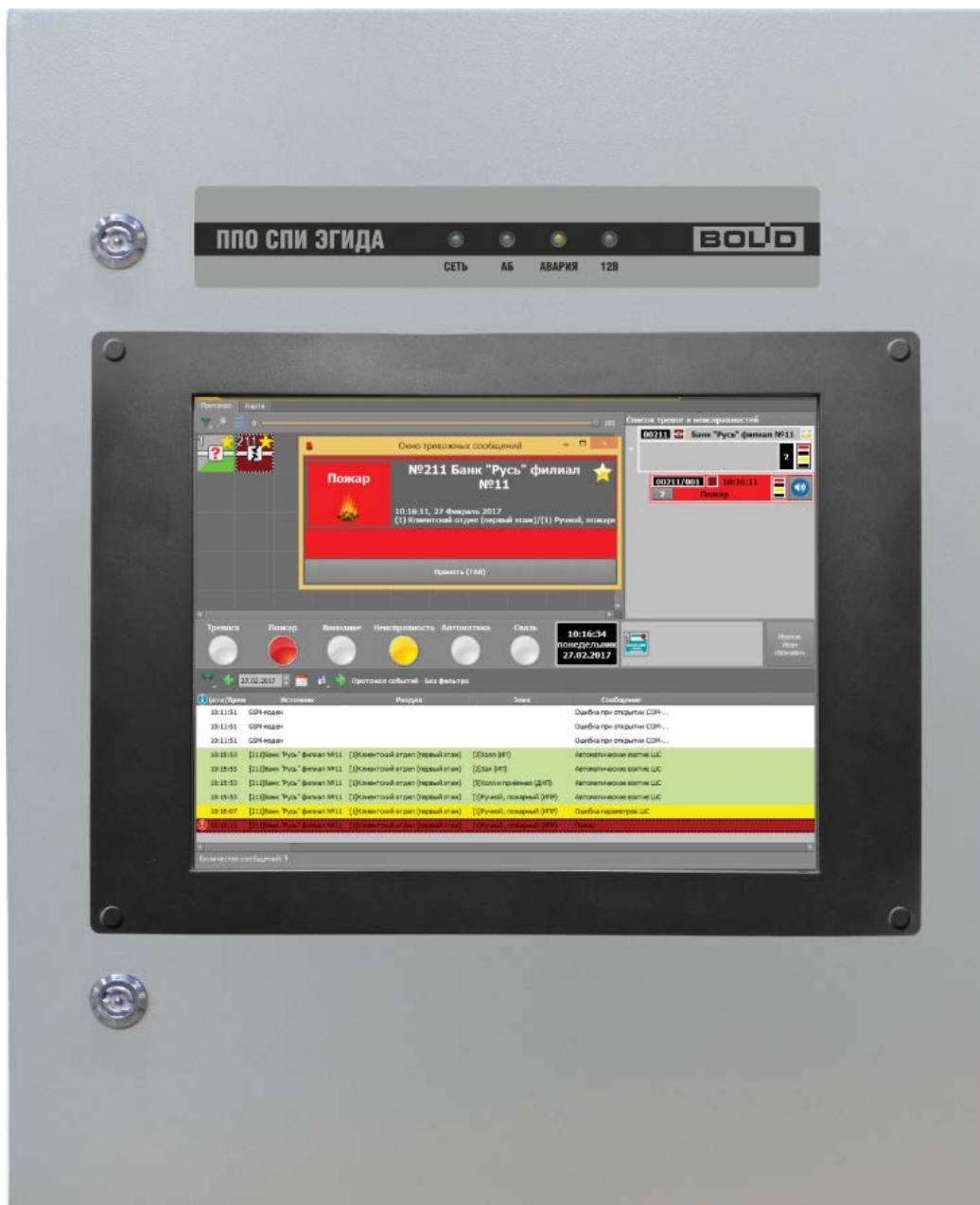
Рисунок 2-1. Внешний вид лицевой панели ППО КСПИ «Эгида»
