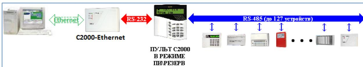
*Схема подключения приборов через Ethernet по протоколу «Орион Про».*
