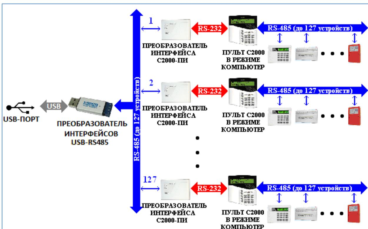
К одному рабочему месту приборы могут подключаться по разным протоколам – к одному порту по протоколу «Орион», к другому порту по протоколу «Орион Про».
