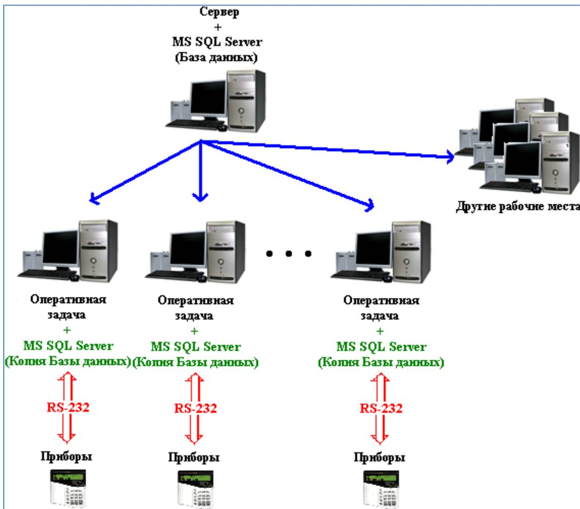
Один «Центральный Сервер системы» является основным, а остальные резервными. При разрыве связи по локальной сети каждое рабочее место, на котором установлен резервный «Центральный Сервер системы», переключается на этот резервный «Центральный Сервер системы» и продолжает работу с резервной копией Базы данных. Каждый резервный «Центральный Сервер системы» работает с той резервной копией MS SQL Server'a, который установлен на одном с ним рабочем месте.
