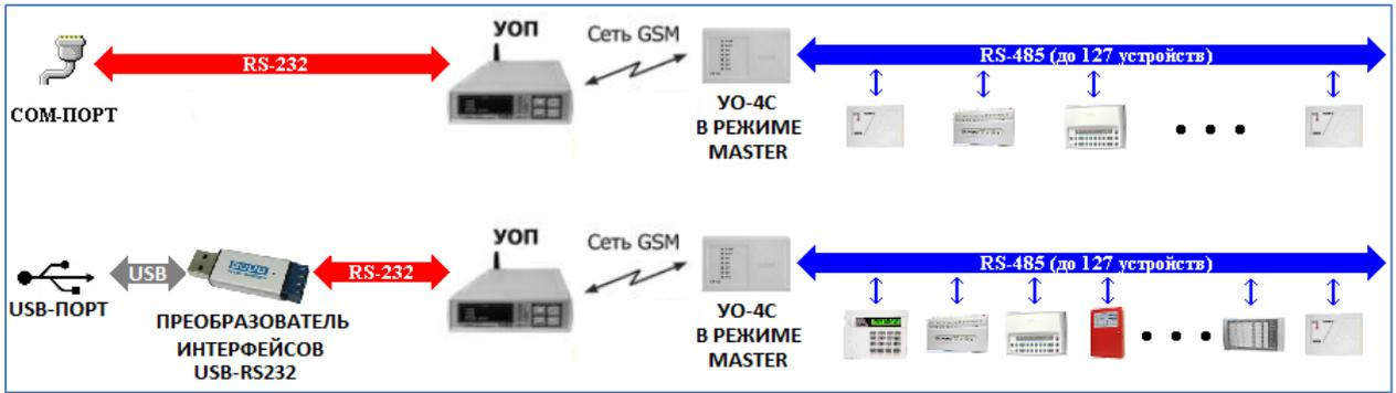
В этом случае «УО-4С» ведёт опрос подключённых к нему приборов и транслирует их события в АРМ «Орион Про».
