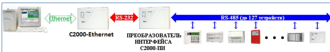
*Схема подключения приборов через Ethernet по протоколу «Орион» с резервированием пульта.*
