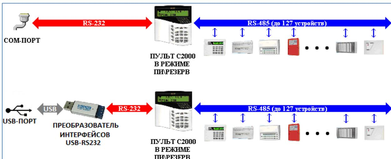
*Схема подключения приборов к одному COM-порту/USB-порту компьютера по протоколу «Орион» (с гальванической развязкой).*
