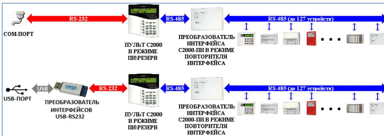
Имеется возможность подключать приборы к компьютеру без резервирования пульта. В этом случае при отключении «Ядра опроса» каждый прибор начинает работать локально, а при включении «Ядра опроса» все события от приборов, которые произошли за время отключения, попадают в АРМ «Орион Про».
