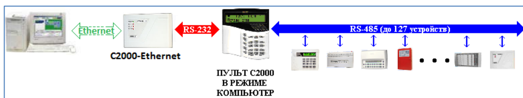
Рисунок 1-11 Схема подключения приборов через Ethernet по протоколу "Орион Про"
