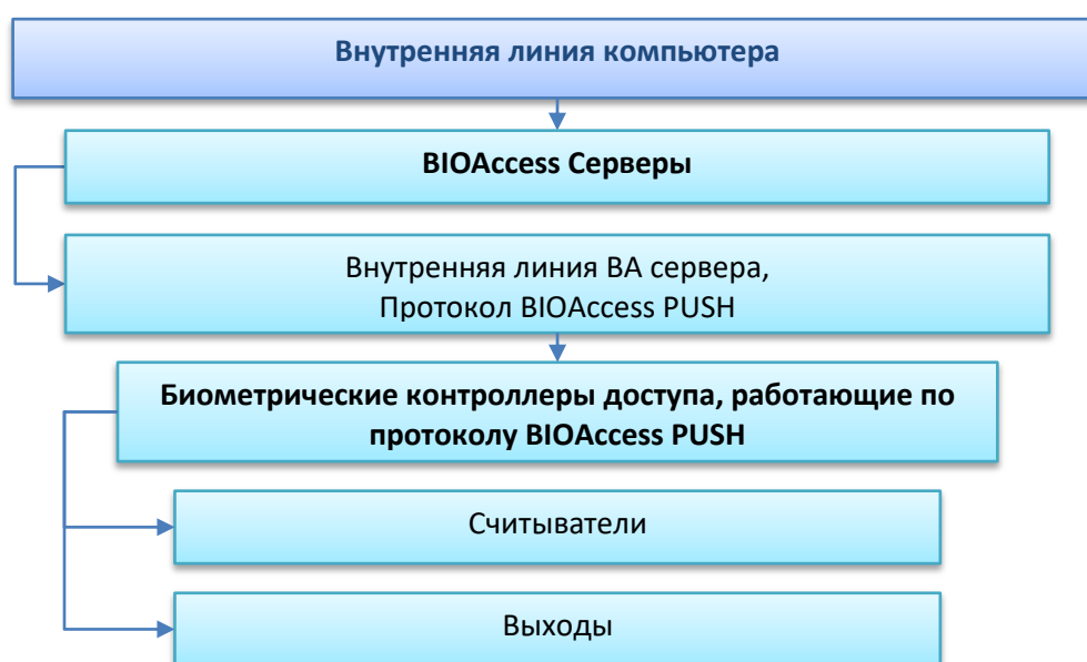
Рисунок 6-72 Схематическое отображение структуры внутренней линия компьютера с интерфейсом TCP/IP и протоколом BIOACCESS BAServer
