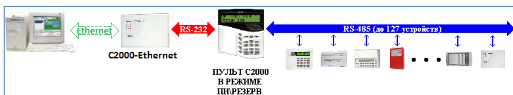
Рисунок 1-10 Схема подключения приборов через Ethernet по протоколу "Орион" с резервированием пультом
