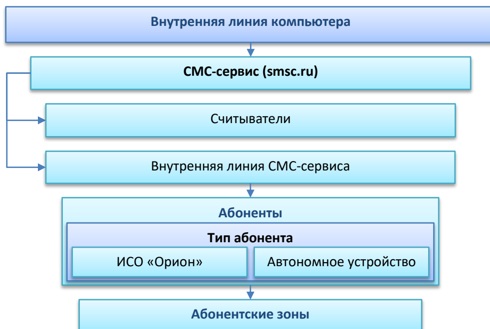
Рисунок 6-70 Схематическое отображение структуры внутренней линия компьютера с интерфейсом TCP/IP и протоколом SMS-шлюз: СМС-сервис (smssc.ru)
