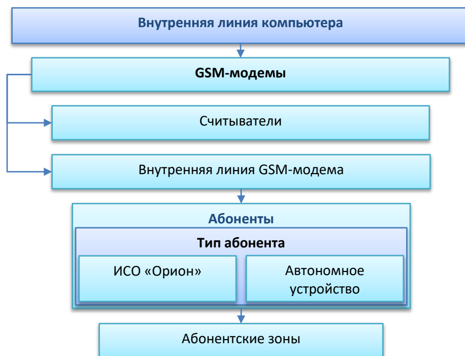
Рисунок 6-68 Схематическое отображение структуры внутренней линия компьютера с интерфейсом RS и протоколом GSM(GPRS) модем
