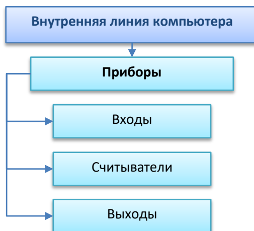
Рисунок 6-65 Схематическое отображение структуры внутренней линии компьютера с интерфейсом RS и протоколом Орион
