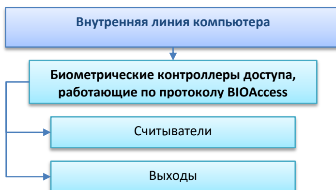
Рисунок 6-73 Схематическое отображение структуры внутренней линия компьютера с интерфейсом TCP/IP и протоколом BIOAccess
