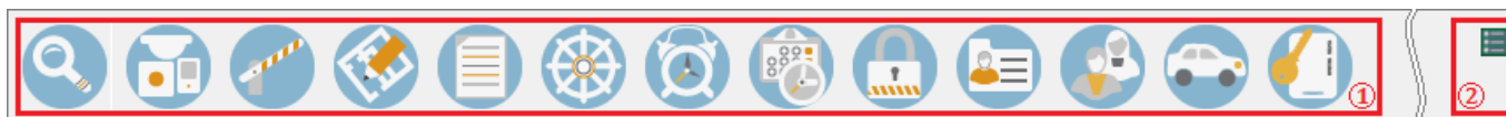
Рисунок 6-18 Панель управления. Здесь 1 – иконки-кнопки переключения между страницами АБД, 2 – индикатор связи с ЦСО
