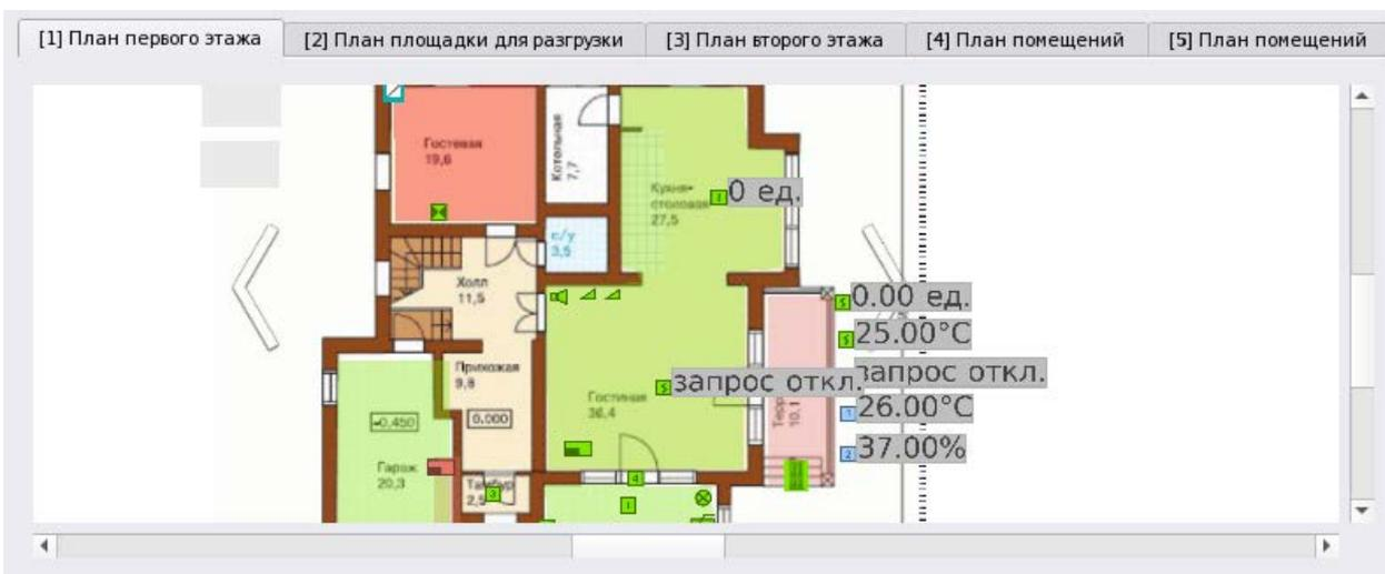
Рисунок 263 – Пример отображения поэтажного плана на рабочем месте
