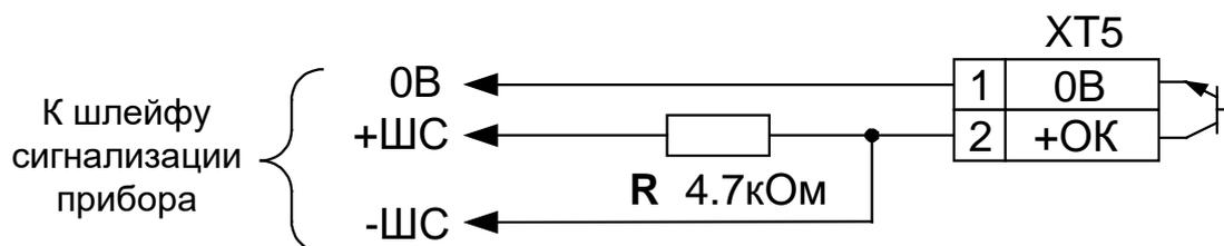
**R** – оконечный резистор шлейфа, устанавливается в корпусе РИП (входит в состав ЗИП приборов)
