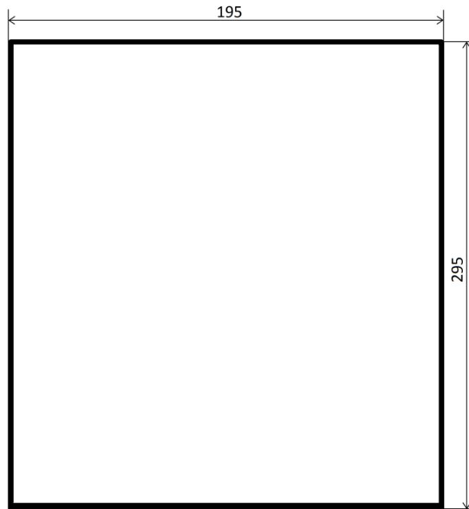
2) Установочные размеры РИП-12 исп.108 (РИП-12-5/17М7-В8) по задней стенке корпуса
