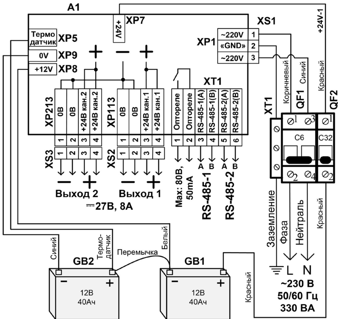
\* Для АБ номинальной ёмкости 26 Ач датчик температуры устанавливать на минусовую клемму АБ GB2 вместе с синим проводом, а белый провод на плюсовую клемму.
