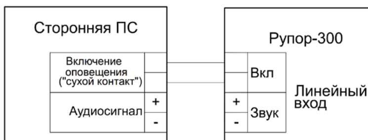
Рисунок 2.2.7. Подключение сторонней ПС к аналоговому входу для запуска сообщения
