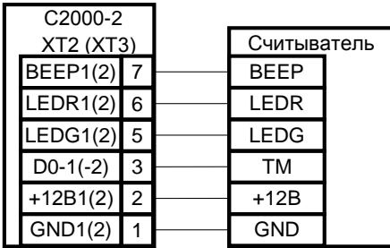
Рисунок 11. Схема подключения считывателей с интерфейсом Touch Memory
