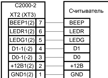
Рисунок 12. Схема подключения считывателей с интерфейсом Wiegand или ABA Track-II
