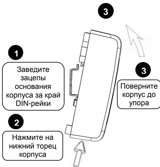
Рисунок 3. Крепление контроллера на DIN-рейку
