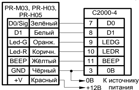
Рисунок 18. Схема подключения считывателей PR-M03, PR-H03, PR-H05
