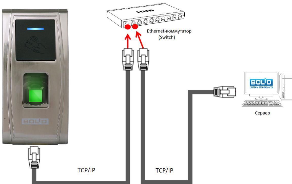
Рисунок 6. Подключение контроллера к ПК через Ethernet-коммутатор (Switch)
