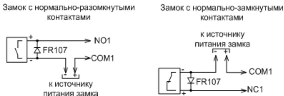
Рисунок 5. Рекомендуемые схемы подключения замков (разъём J10)
