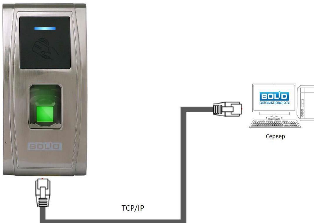
**Рисунок 7.** Подключение контроллера к ПК напрямую
