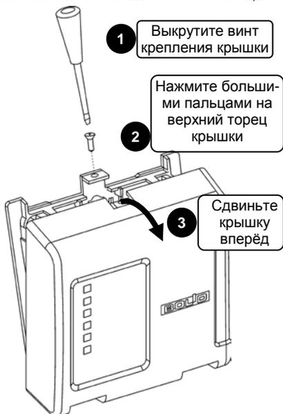
Рисунок 2. Снятие крышки
