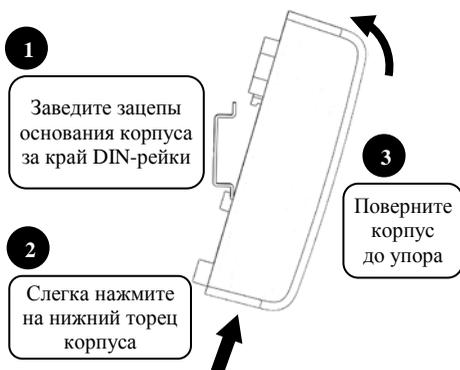
Рисунок 5 Крепление на DIN-рейку
