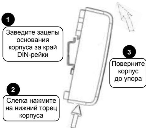
Рисунок 3. Крепление прибора на DIN-рейку
