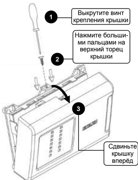
Рисунок 2. Снятие крышки устройства
