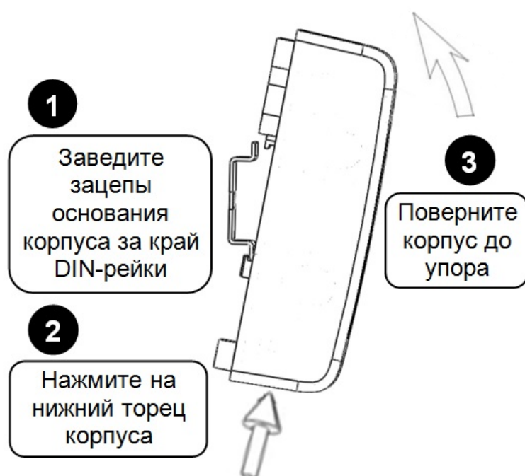
Рисунок 8-3 Крепление на DIN-рейку
