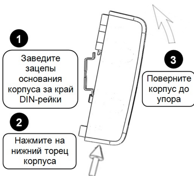
Рисунок 8-3 Крепление на DIN-рейку
