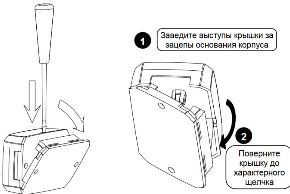
Рисунок 2.3. Снятие и установки крышки преобразователя
