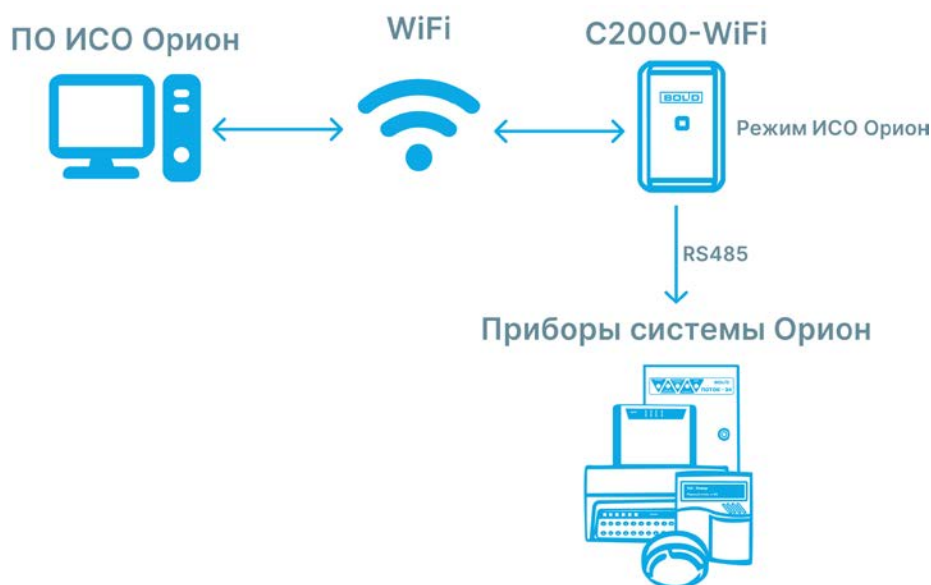
Рисунок 2.6. Подключение «С2000-WiFi» по протоколу «Орион»
