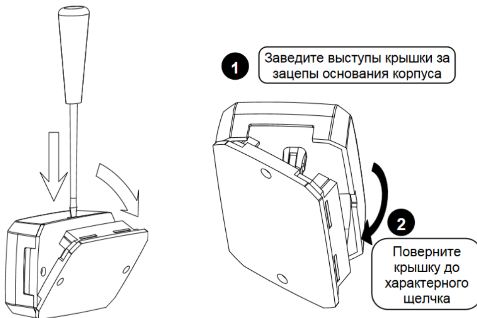
Рисунок 2.3. Снятие и установки крышки преобразователя
