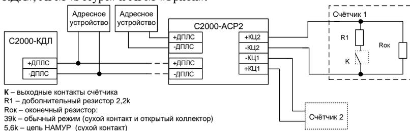
**Рисунок 1.** Схема соединений
