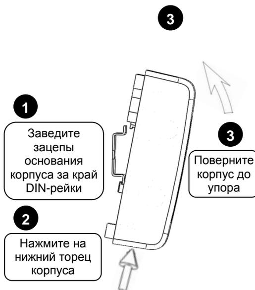
**Рисунок 3.** Крепление АСР8 на DIN-рейку
