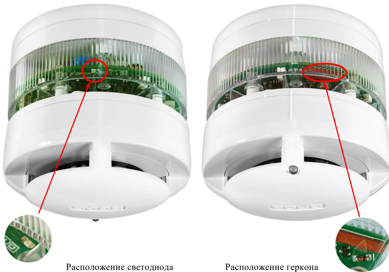
Рисунок 2.2.5.1 Место расположения индикаторного светодиода и геркона
