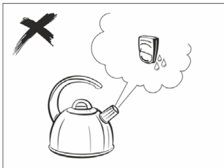
Рис.2.2.3.2. Не устанавливайте извещатель в местах, где на извещателе может образовываться конденсат
