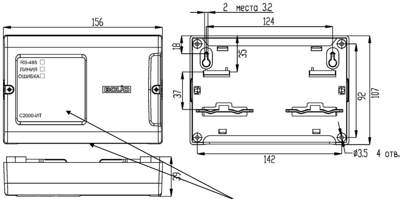
Место установки перемычек XP1, XP3 (под крышкой). Перемычка XP1 установлена – резистор 620 Ом подключен к интерфейсу RS-485, снята – отключен.
