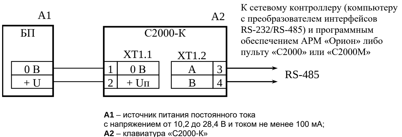
Рисунок 1 Схема подключения клавиатуры «С2000-К» при эксплуатации
