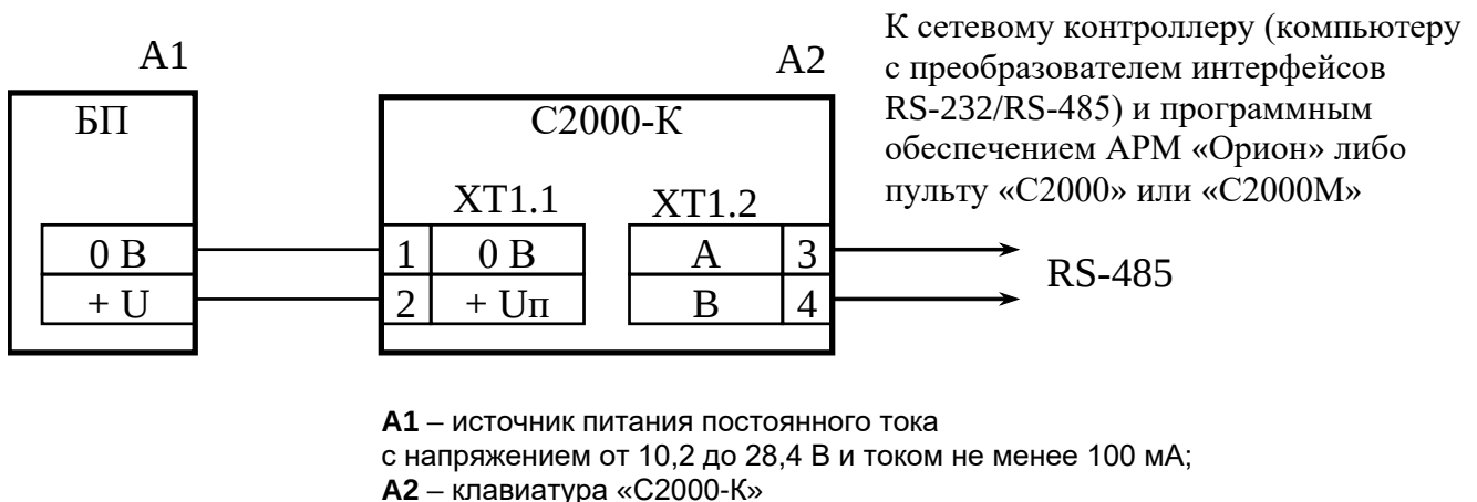
Рисунок 1 Схема подключения клавиатуры «C2000-K» при эксплуатации
