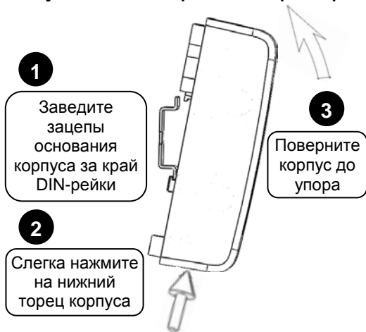
Рисунок 3. Крепление контроллера на DIN-рейку
