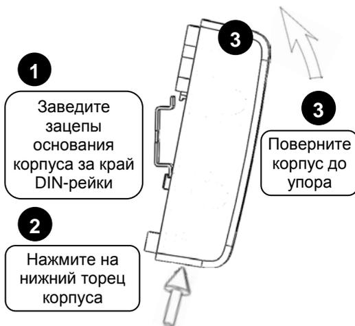
Рисунок 3. Крепление контроллера на DIN-рейку
