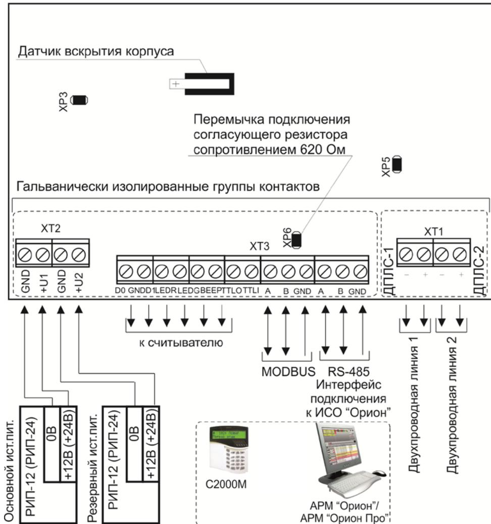
Джампер XP3 предназначен для переключения режима модуля на интерфейсе «Орион»:
