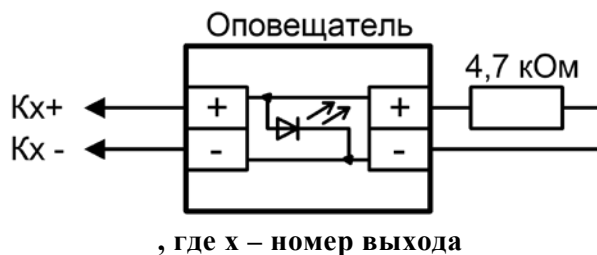
Рисунок 2.2.7. Схема подключения одного полярного оповещателя (исполнительного устройства) к выходу.
