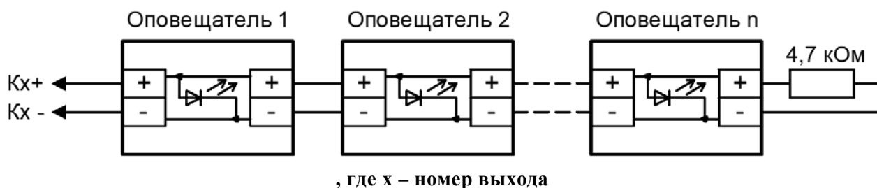
Рисунок 2.2.8. Схема подключения нескольких полярных оповещателей (исполнительных устройств) к одному выходу прибора.
