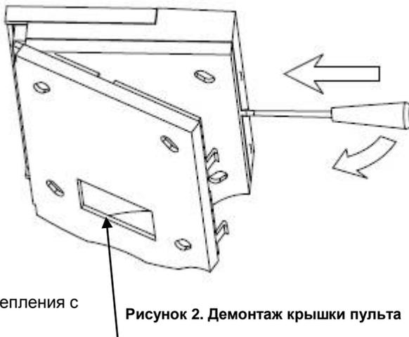
Рисунок 2. Демонтаж крышки пульта
