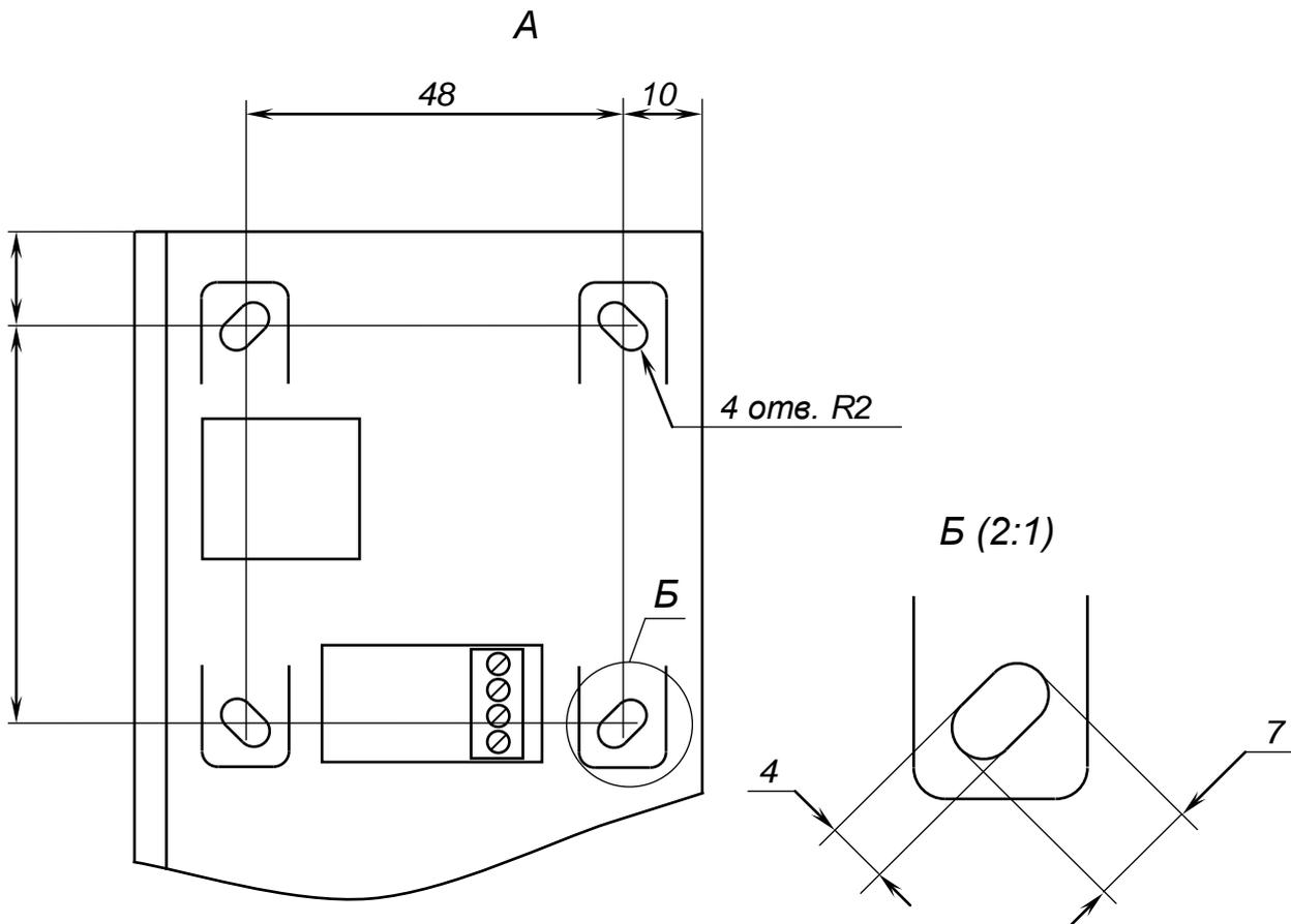
Рисунок 2 Габаритные и установочные размеры "С2000-КС"
