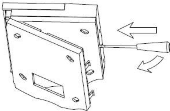
Рисунок 3 Демонтаж крышки пульта
